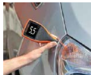
Obrotowy wyświetlacz (360°) ułatwiający odczyty pomiarów pod dowolnym kątem
