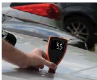
Pomiary na podłożu stalowym i aluminiowym
